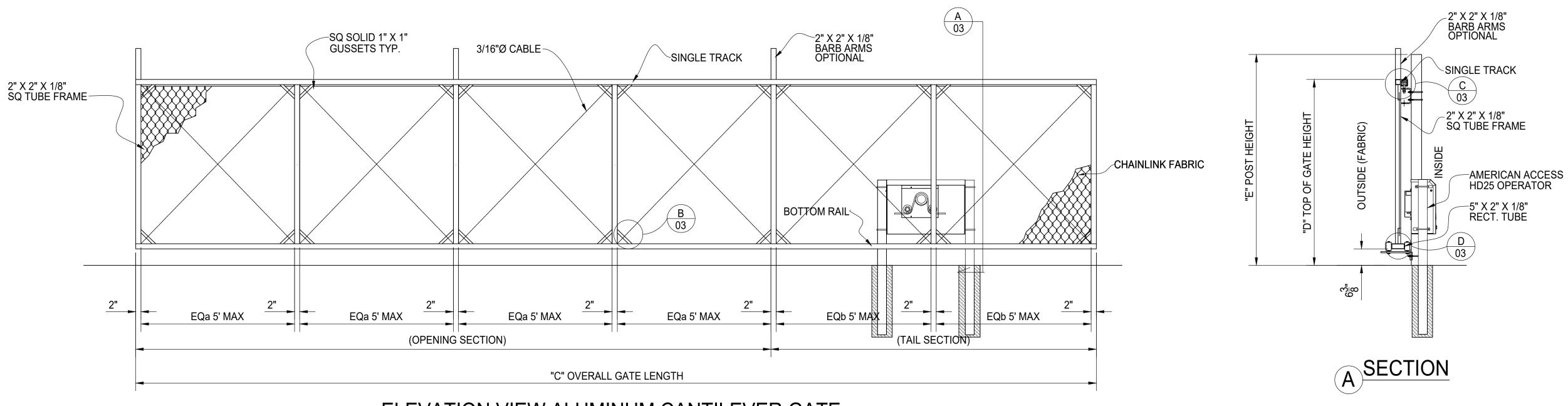
ELEVATION VIEW ALUMINUM CANTILEVER GATE
