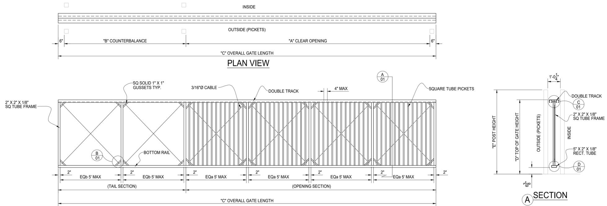
**ELEVATION VIEW ALUMINUM CANTILEVER GATE
