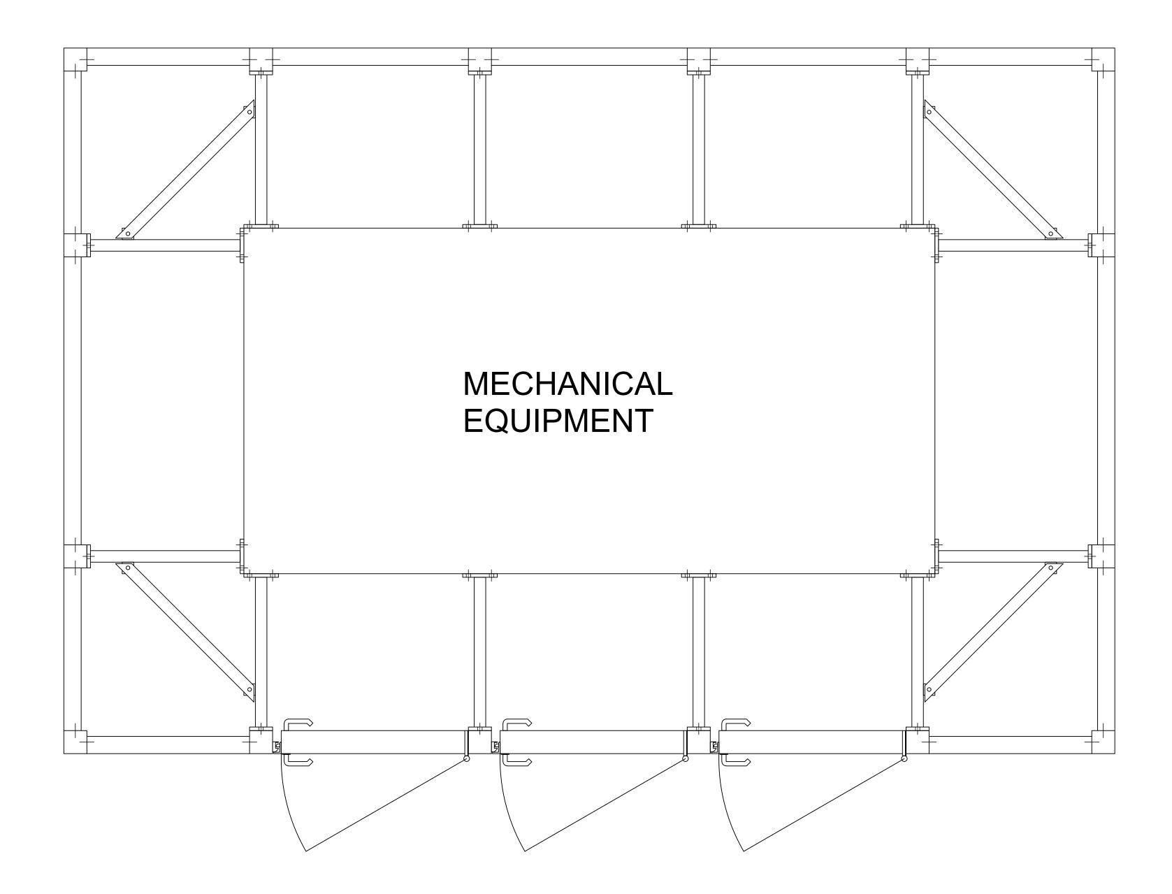
CANTILEVER TRUSS ENCLOSURE - PLAN VIEW
