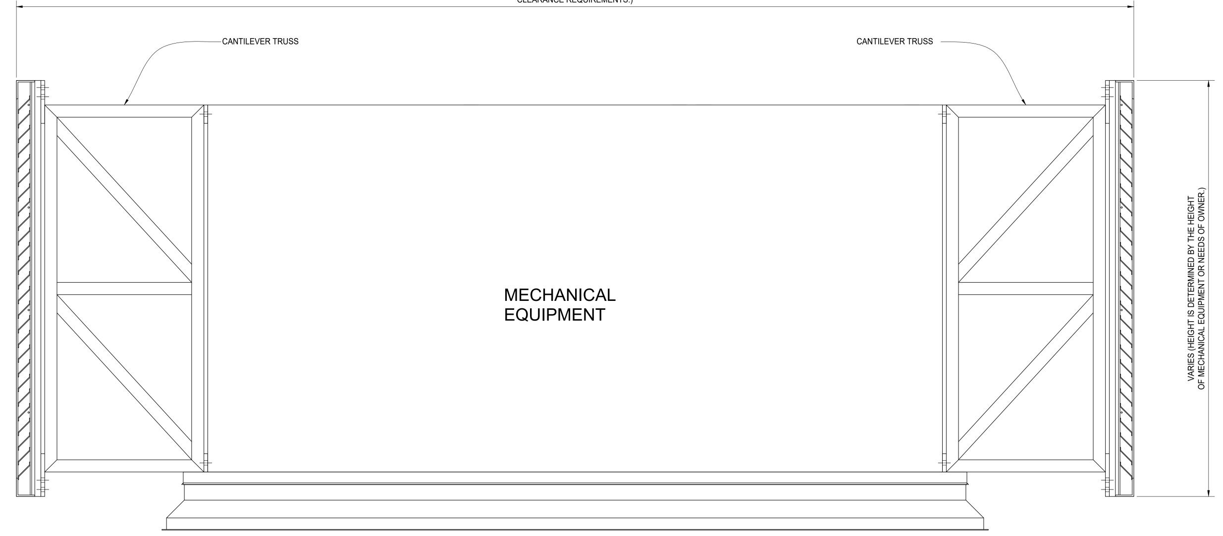
CANTILEVER TRUSS ENCLOSURE - ELEVATION SECTION VIEW
