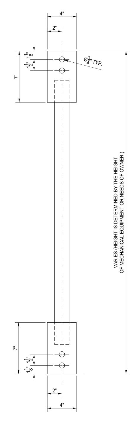
CANTILEVER TRUSS DETAIL
